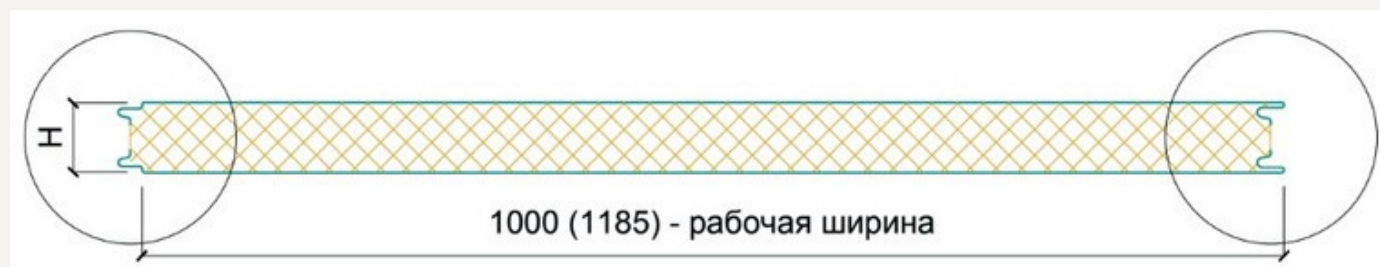
Сечение стеновой панели. 1000 (1185) мм — рабочая ширина
