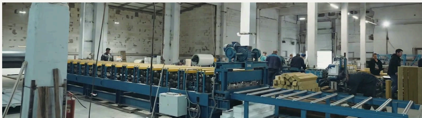
Линия производства сэндвич-панелей ЗСМ-ПРОФИ.
