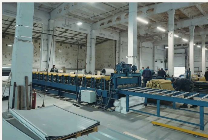
Линия производства сэндвич-панелей ЗСМ-ПРОФИ. Срез панели с минеральной ватой.
